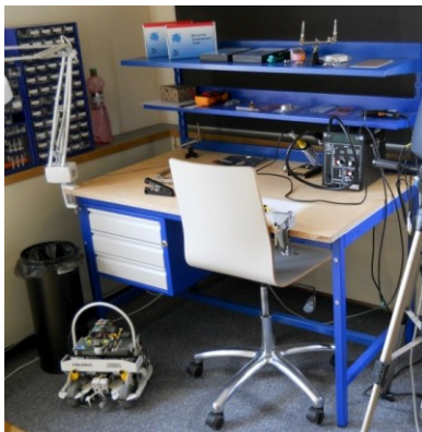
Obrázek 9 – Technické montážní a pájecí pracoviště výzkumné skupiny STRaDe
